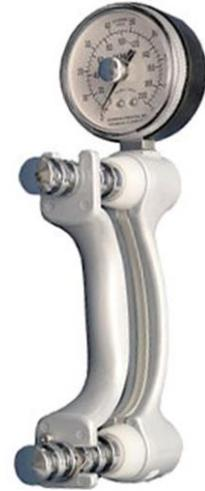
**Fig. 1. Jamar™ Hand Dynamometer**
